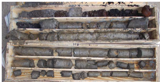
Extrait de la carotte du forage FP8 : remblai pollué
